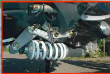
Gut versteckt: Federbein unter dem Motor.
