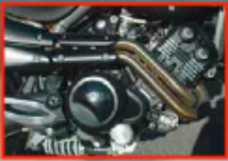
Das moderne Einspritztriebwerk mit 72° V-Anordnung.
