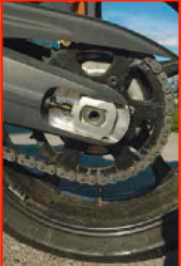
So wie der Kettenspanner in der Leichtmetallschwinge sind viele Teile sorgfältig bearbeitet.
